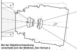
verschiebt sich der Bildkreis. Den Verlust a durch die Kippung fängt die Reserve auf (siehe oben); der bei c vignettierte Gewinn b wird für Abwärts-Shift nutzbar.
