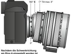
(hier im Bild mit 0° nach unten), kann das Objektiv durch Drehen des Rings B in Aufnahmerichtung gesehen nach rechts um bis zu 8° geschwenkt werden. Der Schwenkwinkel ist an der Winkelskala E des Drehrings B ablesbar.
