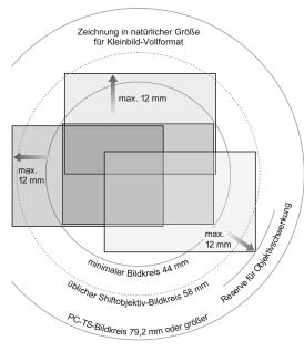
Der Bildkreis aller PC-TS-Objektive ist größer als allein für die Parallelverschiebung nötig, um gleichzeitig auch eine Objektivschwenkung nach Scheimpflug zu ermöglichen.
